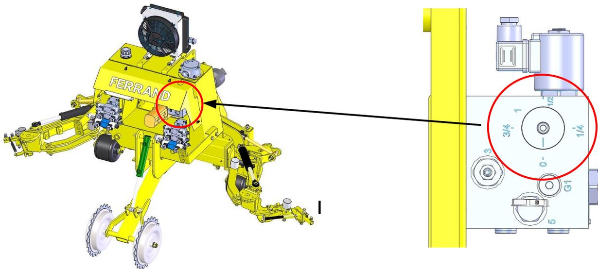
Avant toutes intervention sur le régulateur, éteindre le tracteur. La molette (1) permet de régler la vitesse de rotation de l'outil attelé en modifiant le débit d'huile. Desserrer le contre-écrou avant tout réglage.
