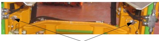
Les panneaux verticaux s'inclinent manuellement de 10° maximum en desserrant les 2 écrous.
